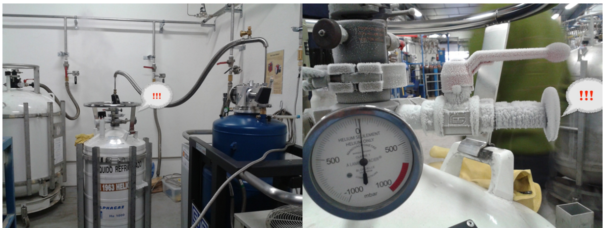
Figura 31: Izquierda: Transferencia de helio subenfriado desde un ATL80 a un Dewar de transporte. Derecha: Detalle de la salida de gas evaporado. No se observa condensación de vapor de agua del aire debido a que el helio que se transfiere está subenfriado y la cantidad que se evapora durante la transferencia es muy pequeña. Tan solo produce condensación en la válvula metálica de salida de gas, pero no produce condensación de vapor de agua del aire como es habitual cuando se transfiere helio en el punto normal de ebullición. De hecho, normalmente, una llamativa nube de vapor de agua, totalmente ausente en este tipo de transferencias de helio subenfriado, asciende arrastrada por el vapor de helio evaporado durante la transferencia.
