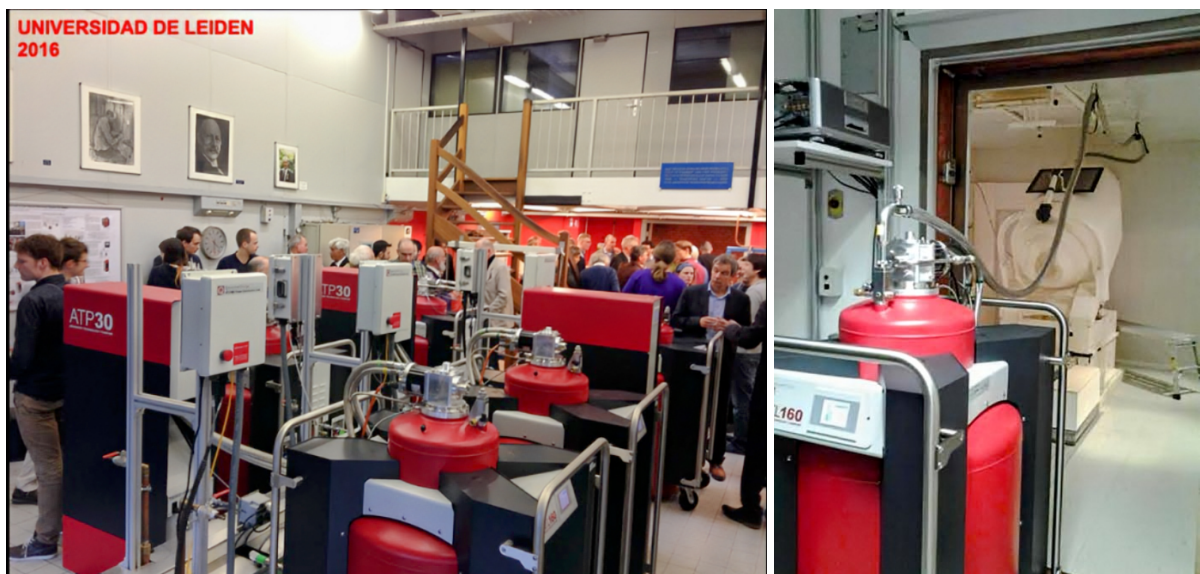
Figura 17: Izquierda: Inauguración del Departamento de Criogenia de la Universidad de Leiden. Derecha: Transferencia de Helio líquido desde un ATL160 a un Magneto-encefalógrafo (MEG) de un hospital. El ATL ha estado recuperando el helio evaporado en el MEG directamente, sin necesidad de equipos auxiliares como globos, compresores, bloques de botellas de alta presión o purificadores.
