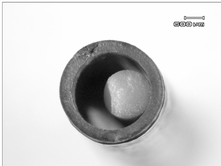
**Fig. 19.** Sección del ánodo (Cermet de YSZ:Ni) de una SOFC tubular fabricada en el ICMA.
