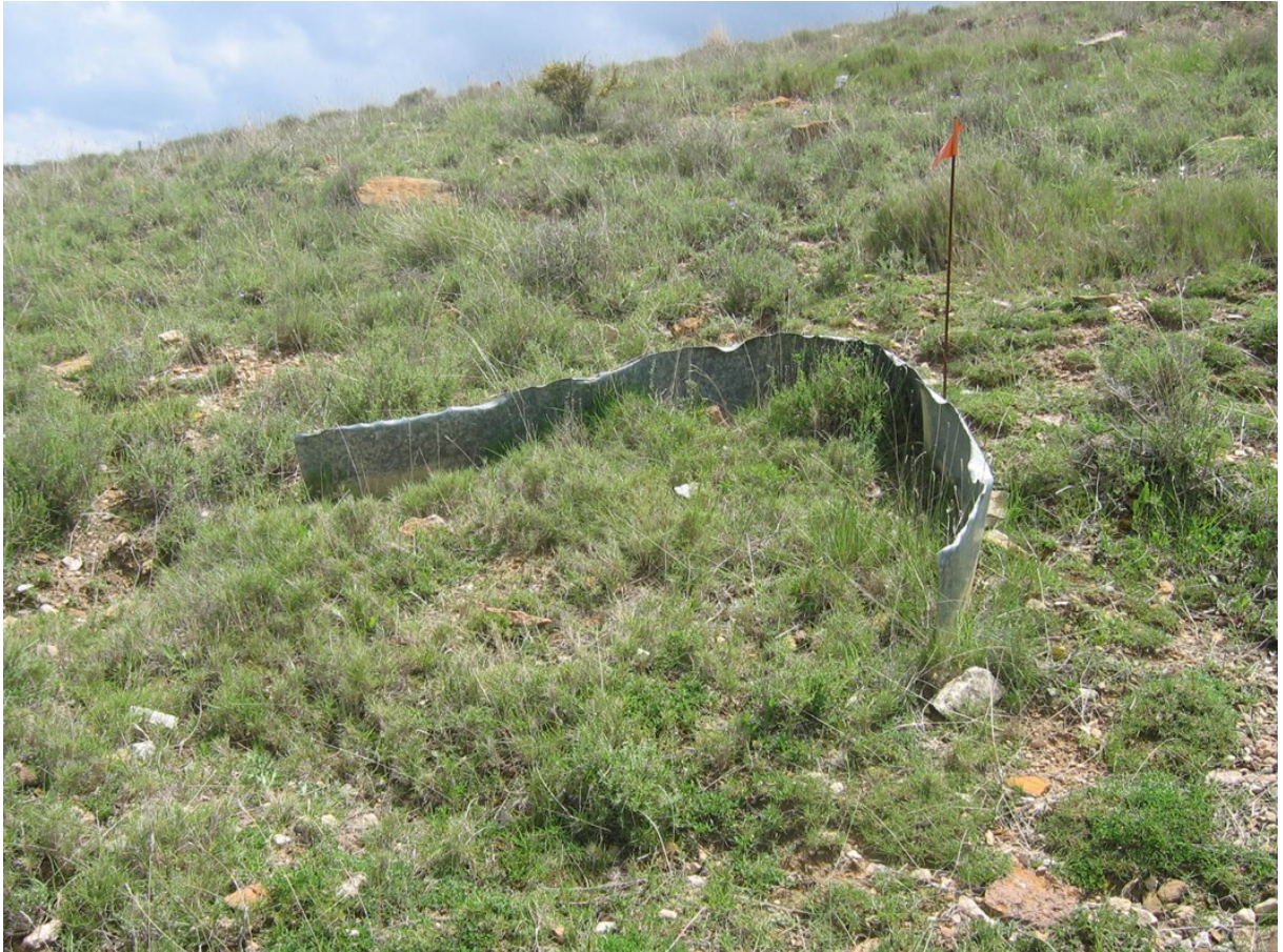
Figura 12: Ejemplo de dispositivo de exclusión de la llegada de la escorrentía desde el claro superior exportador a la mancha de gramíneas inferior (importadora).
