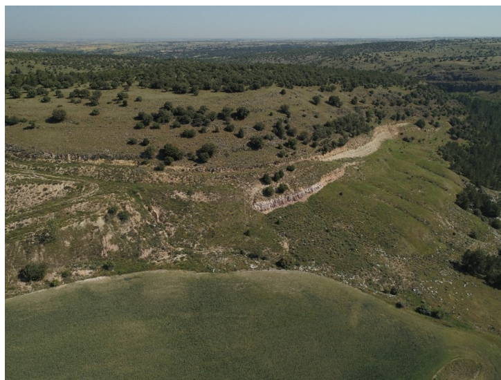
Figura 24: Aspecto de la cantera de La Higuera en 2020, 12 años después de su restauración. Se aprecian los cauces sub-paralelos de las cuencas en ladera y el establecimiento de una comunidad vegetal con alta cobertura, no limitada por procesos erosivos. Fotografía: J.F. Martín Duque.
