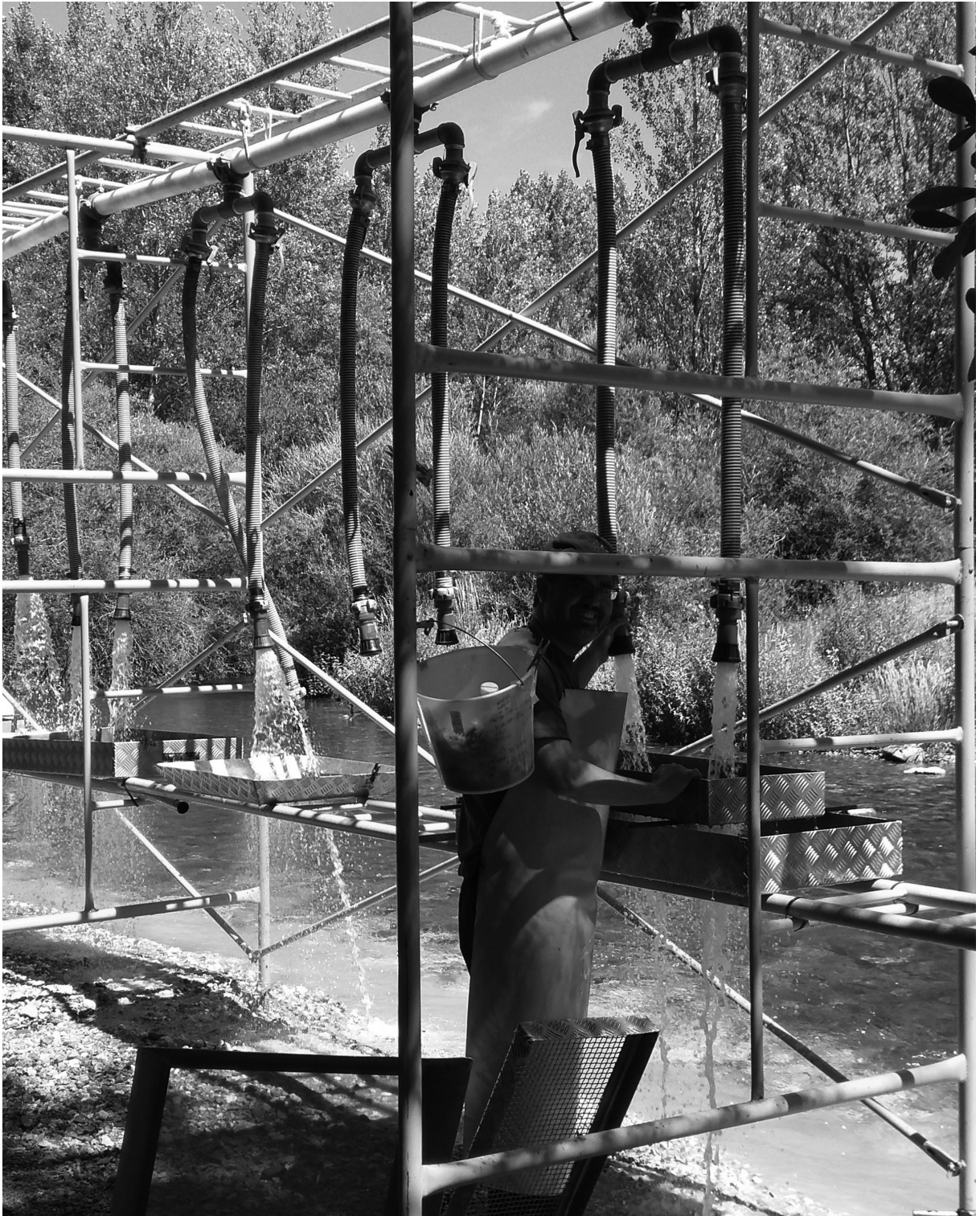
Figura 1: Mesas de lavado-tamizado para procesar grandes muestras de sedimentos con fósiles de microvertebrados.
